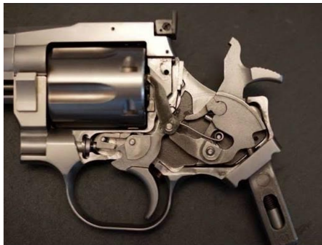
Revolver sin percutor en el martillo, el percutor se encuentra en el armazón.
