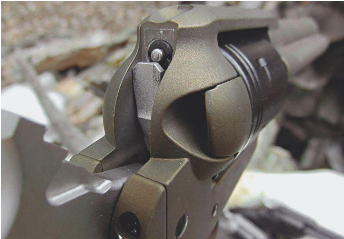
Detalle de la tapa de carga. Revolver con percutor integrado al armazón
