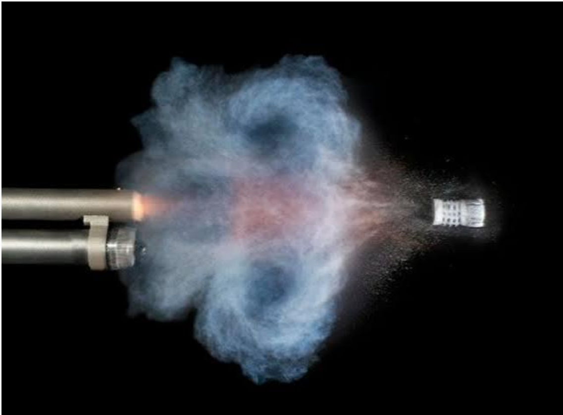
Foto de disparo de escopeta antes de la separación del taco contenedor.
