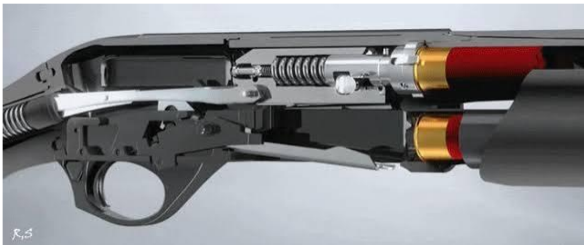
Esquema de funcionamiento de una escopeta semiautomática.
