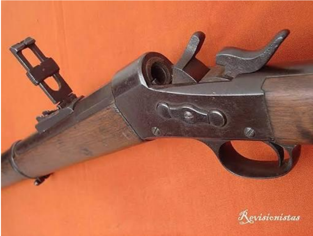
Fusil Remington "Patria" con sistema rolling block.
