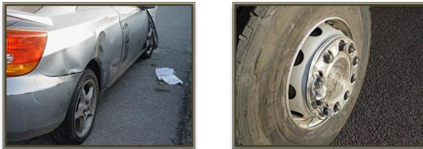
Correspondencia de daños
