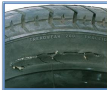
Rotura localizada de la lona de la carcasa
