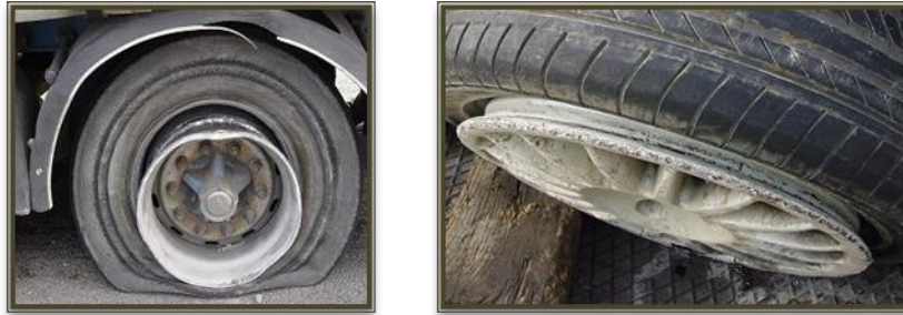
Desllantado y abrasiones en la llanta
