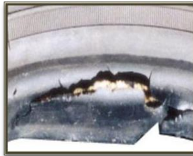
Deterioro del talón
