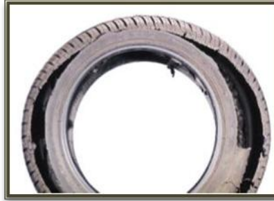
Rotura circular de la carcasa
