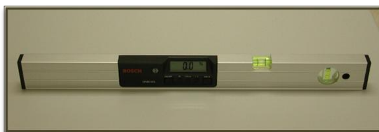
Inclinómetro digital (Bosch) para medición de pendientes y peraltes
