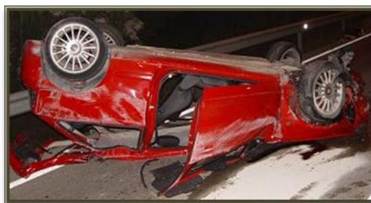
Vuelco en tonel, determinado por el sentido de los arañazos en el lateral
