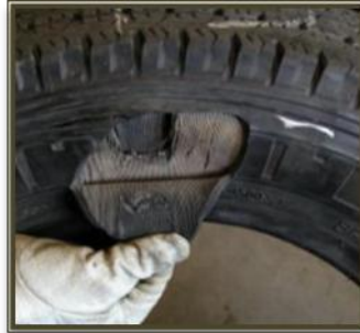
Deterioro en ruedas gemeladas
