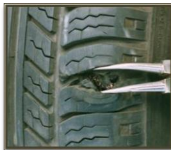
Rotura por corte
