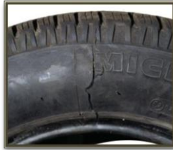
Rotura del flanco
