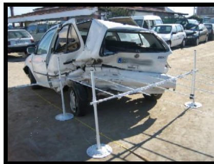
Medición de las deformaciones de un vehículo mediante un instrumento de barras.
