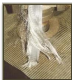
Rotura por tensión
