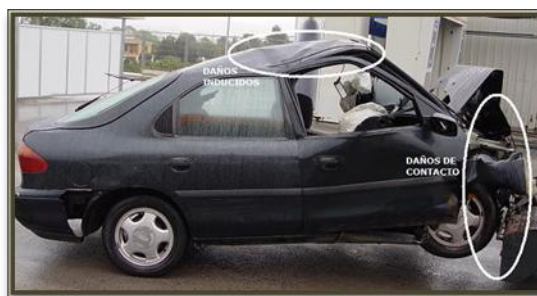
Localización de daños de contacto e inducidos
