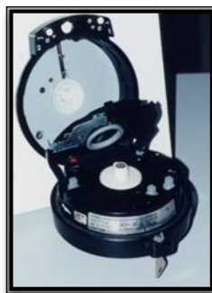
Tacógrafo para dos conductores (la tapa central separa ambos discos)
