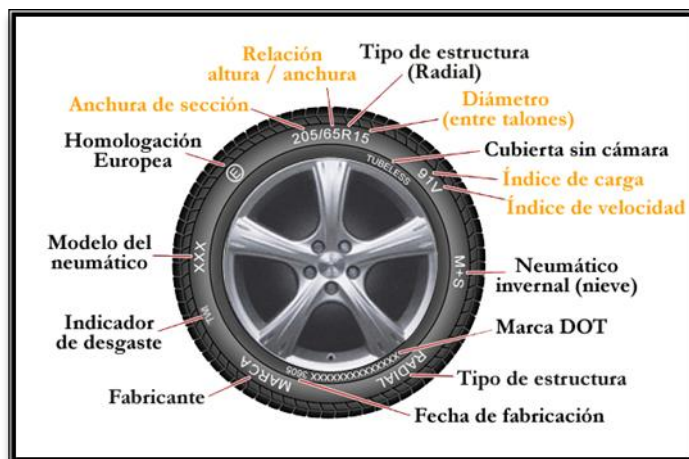
Ejemplo de nomenclatura y marcas de un neumático
