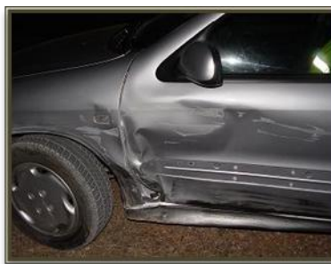
Ejemplo de transferencia de pintura entre dos vehículos
