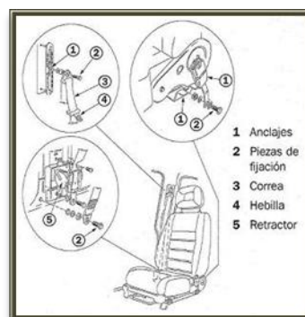
Elementos que forman parte del sistema del cinturón de seguridad (Fuente: CESVIMAP)
