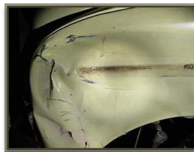
Ejemplo de transferencia de pintura entre dos vehículos
