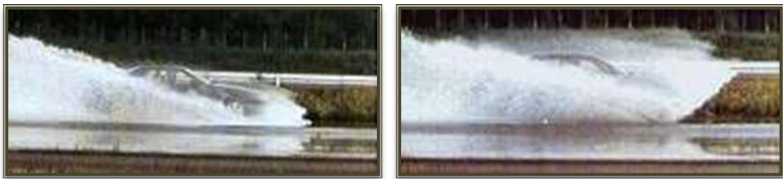
Efectos de drenaje de un neumático, siendo insuficiente en la fotografía de la derecha
