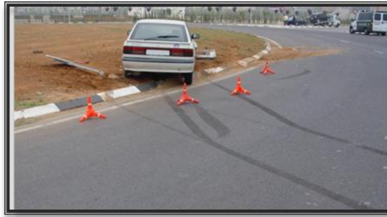
Huellas de deslizamiento
