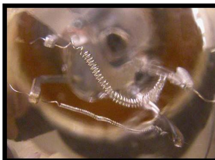
Lámpara de filamento dual freno/luz trasera. El filamento fino de la luz trasera no estaba incandescente, aunque estaba caliente por la luz del filamento del freno.
