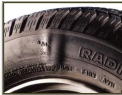
Rotura de la carcasa por choque
