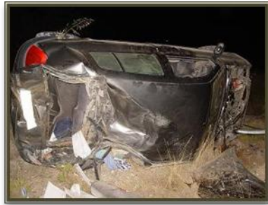
Vuelco de campana o volteo. Obsérvese el sentido de los arañazos del techo y su hundimiento
