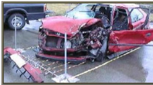
Barra de medición de deformaciones
