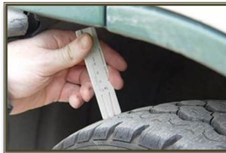
Medición de la profundidad del dibujo con un profundímetro
