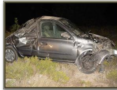
Vuelco de campana o volteo. Obsérvese el sentido de los arañazos del techo y su hundimiento
