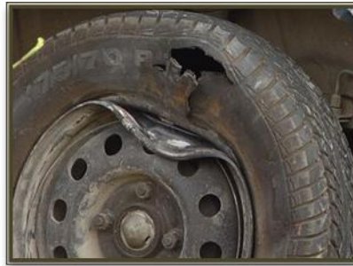
Talón roto más corte y deformación axial de la llanta
